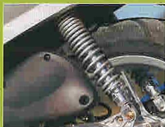
Federbeine schwach gedämpft
