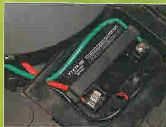
Akku wartungsarm, tief liegend
