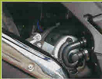
Wasserpumpe sitzt rechts
