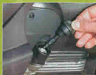
Ölstand checken per Peilstab
